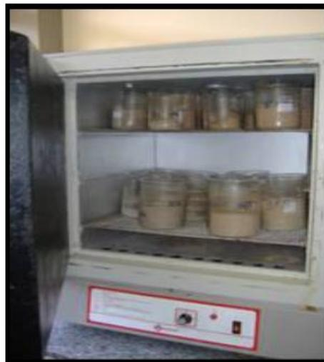
Figura 2: Estufa para secagem de amostras dos sedimentos arenosos
