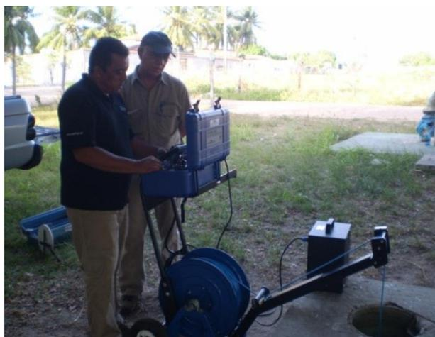
Figura 4 - Perfilagem óptica em poço tubular profundo
