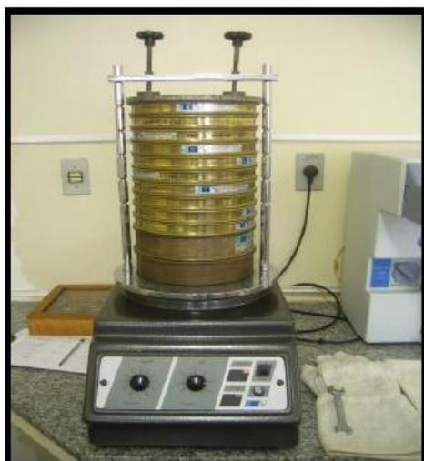
Figura 1: Peneirador e jogo de peneiras utilizados para a separação por vibração mecânica, das classes granulométricas dos sedimentos arenosos
