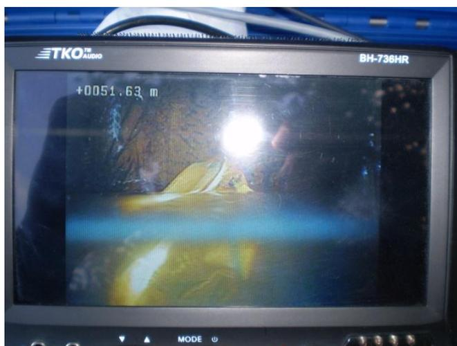
Figura 1 – Medição e imagem do nível estático obtida durante perfilagem
