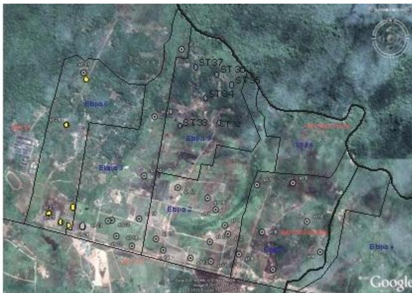
Fig. 1 – Loteamento Cidade Jardim com as 6 etapas do licenciamento e a Localização dos furos de sondagem realizados tendo ao fundo a área da UFPA.
