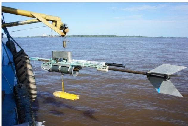
Figura 02 – Equipamento Callède e sonda de qualidade de água.
