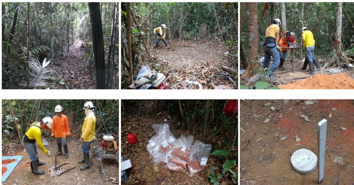
Figura 1 - Sequência da operação: (1) abertura de acesso; (2) preparação da praça de sondagem; (3) e (4) sondagem a trado; (5) amostras coletadas; e (6) furo tamponado.
