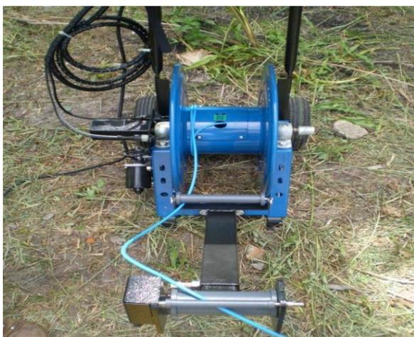
Figura 3 - Guincho do Perfilador óptico
