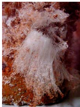
Figura 8 – Detalhe da morfologia dos cristais de carbonato de sódio hidratado.
