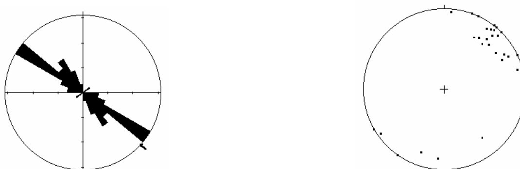
Figura - Diagramas de pólo e roseta indicando o alto valor do mergulho e a direção preferencial das foliações S_0
