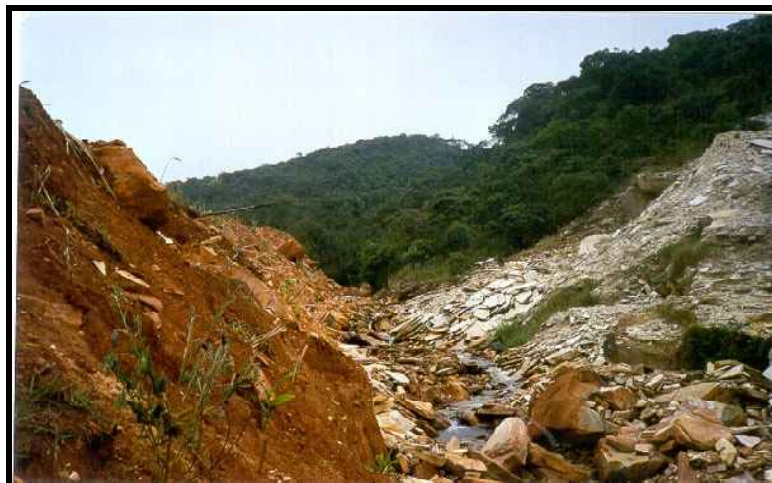
Figura 2. A escavação dos depósitos de quartzito envolve a remoção do solo superficial e das rochas do capeamento.
