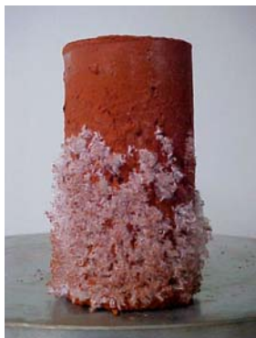
Figura 7 – Crescimento dos cristais de carbonato de sódio hidratado
